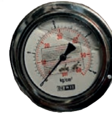
MANÓMETRO DE GLICERINA 4P DE 0 A 4 KG. CON POST DE 1/4 NPTDEWIT 02-0081
