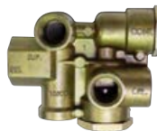
SEALCO VÁLVULA CONTROL FRENO T10500 20-0059
